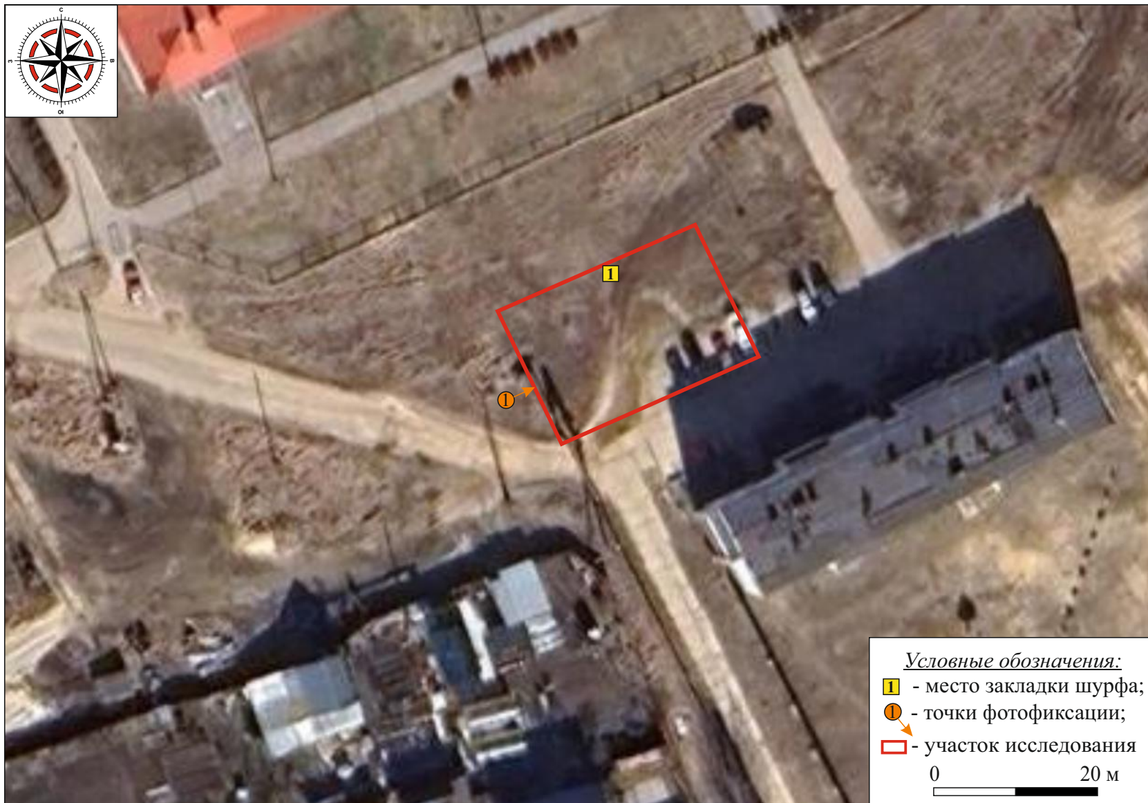
Илл. 7. Нижегородская обл., Лысковский м.о., строительство блочно-модульной котельной (на природном газе) в с. Валки, пер. Школьный - 2026 г. Космоснимок с нанесением участка исследования и расположением шурфа (источник космоснимка: google.ru, дата съемки 2025 г.).
